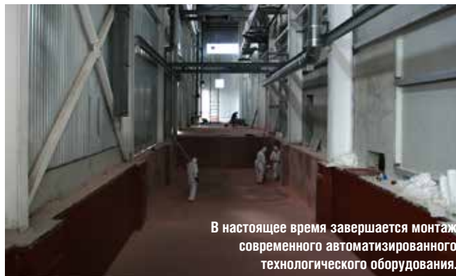
Новая ванна для оцинкования позволяет наносить защитное покрытие на металлоконструкции с максимальными размерами до 12,5x1,7x2,9 метра.
